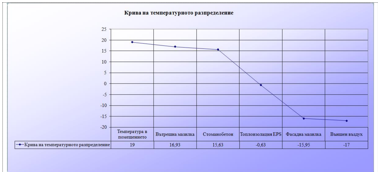
Фиг.9.5 Схема на кривата на температурното разпределение през външната стена Тип 11
